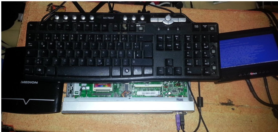
Der Installationsaufbau des CarPC; Basierend auf einem Igel Thinclient.
